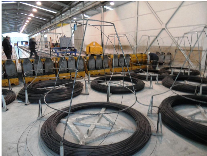
Nave de pretensados, con las armaduras activas listas para ser desenrolladas y extendidas a lo largo de los moldes
